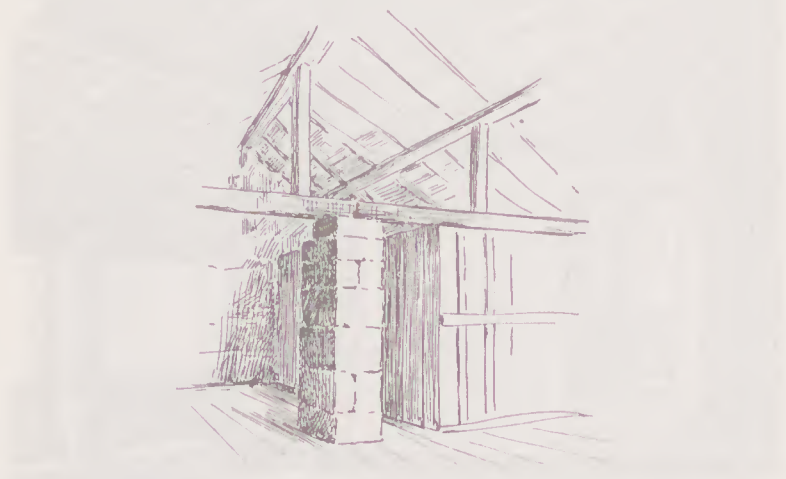
Fig. 6—Coluna de pedra para sustentar o travejamento.
