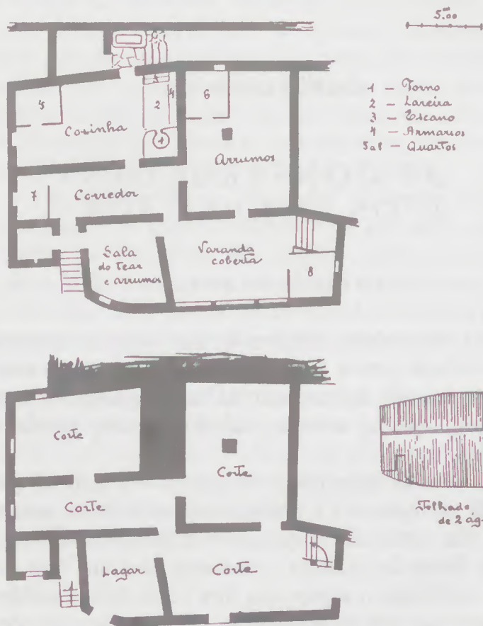
Fig. 2—Planta da casa da família Trigo. Reparar na espessura da parede que sustenta a lareira e o forno, quando não é possível assentá-los directamente no solo.
