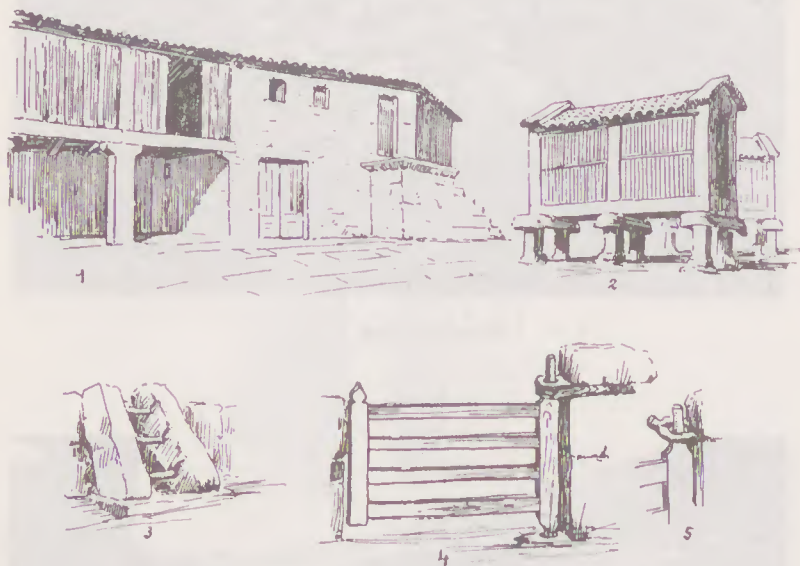
Fig. 7—1) Sequeira seguida de ladrilho. 2) Canastros. 3) Escadas de degraus móveis, para impedir a entrada nas hortas. 4) Cancela. 5) Engonço da cancela.
