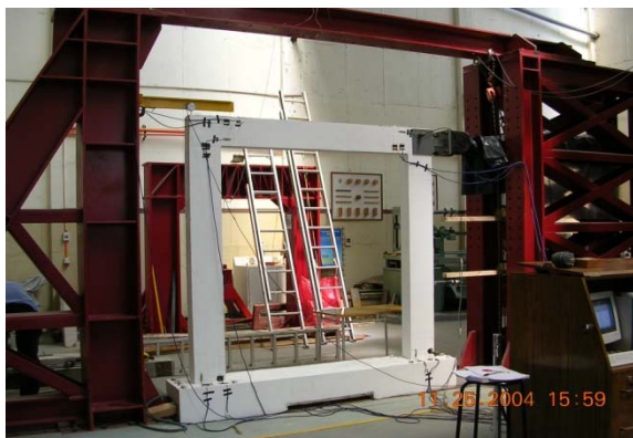
Figura 3 Pórtico instalado en marco de reacción de laboratorio de la U. de La Serena (Chile).
